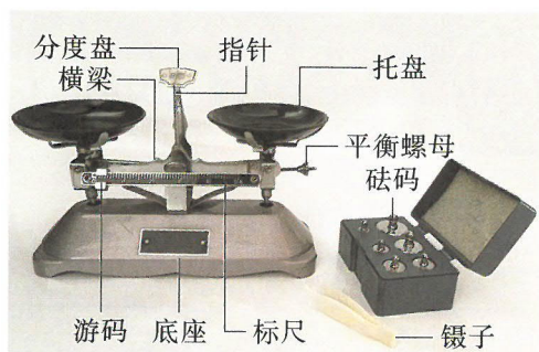
(a) 托盘天平的结构示意图
